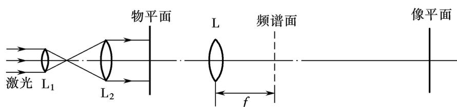
图 2 阿贝成像原理实验光路示意
